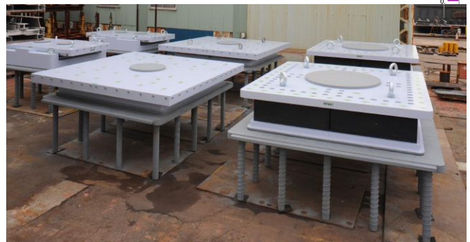
すべり型免震支承仮組状況
