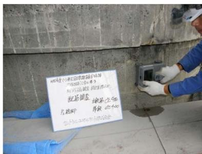
写真-4 配筋調査(探査)の状況
