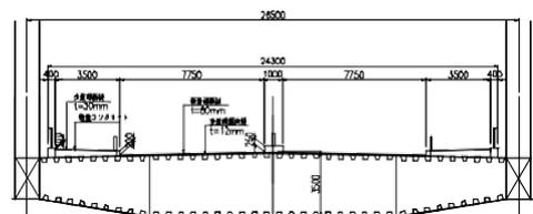
図-3 トラス・鋼床版一体構造
