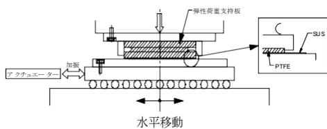
図-7 载荷実験の概要
