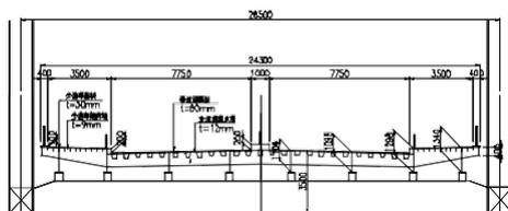
図-2 トラス・鋼床版分離構造
