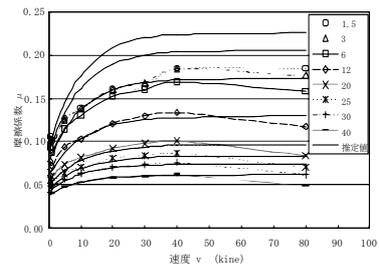
図-8 面圧、速度依存性に関する载荷実験結果
