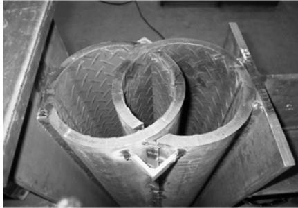
図-4 縞鋼管継手
