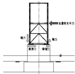
図-6 地震時の摩擦力変化
