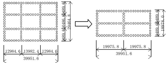
図-5 縞鋼管継手採用による効果
