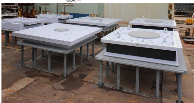
すべり型免震支承仮組状況
