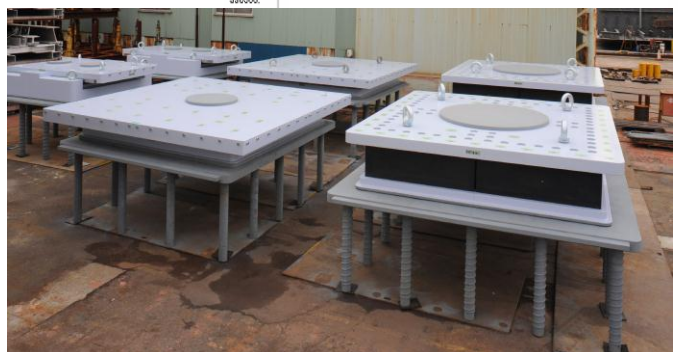
すべり型免震支承仮組状況 (左奥：端橋脚可動巻、中：中間橋脚鉛直巻、右：中間橋脚水平巻)
