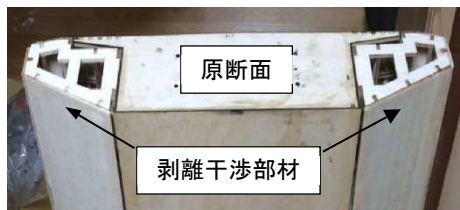
写真-3 剥離干渉部材の設置状況
