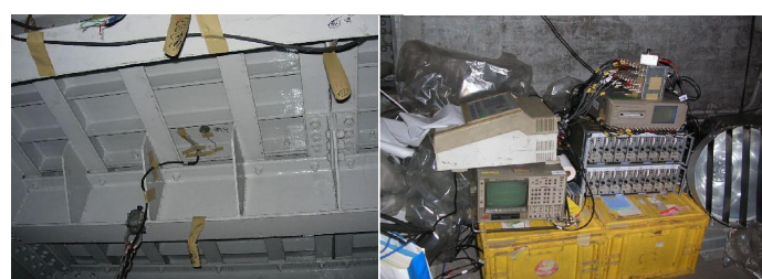
写真-4 ひずみゲージ取付け・計測状況
