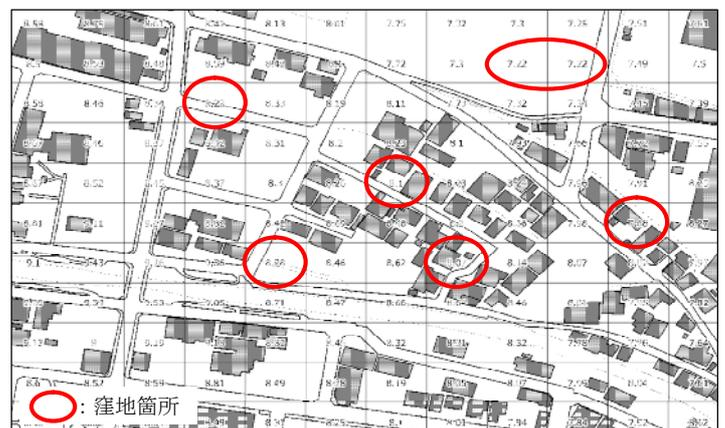
図 2 平均地盤高および窪地箇所
