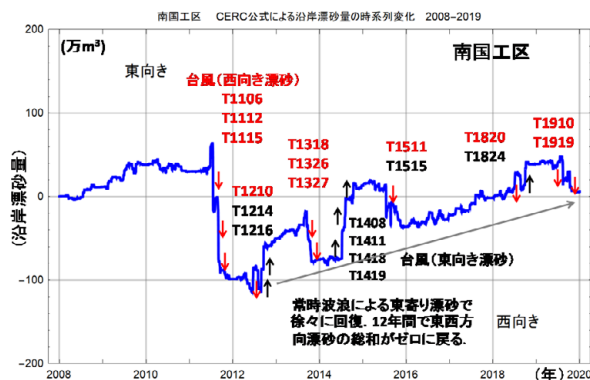
図-3 CERC 公式で推定した南国工区沿岸漂砂の時系列特性
