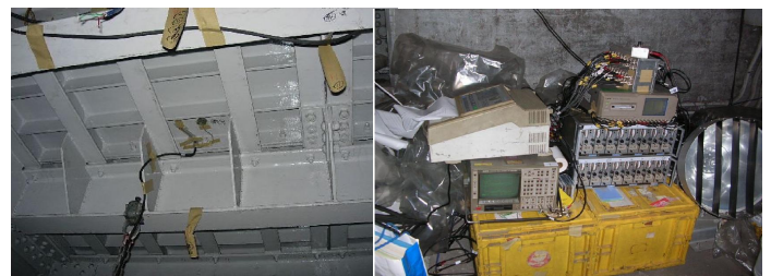
写真-4 ひずみゲージ取付け・計測状況
